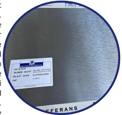
Bezüglich Biegen und Umformen ist die Legierung 1060 H24 aufgrund ihrer hohen Bearbeitbarkeit sehr gut geeignet. Diese Legierung erzielt bei Umform- und Biegeprozessen in der Automobil-, Bau- und Verpackungsindustrie gute Ergebnisse. Ihre Verwendung ist jedoch in hochvibrationsintensiven Umgebungen eingeschränkt. Aufgrund der niedrigen Festigkeit wird diese Legierung in Anwendungen mit hohen Belastungen und Vibrationen nicht bevorzugt.
